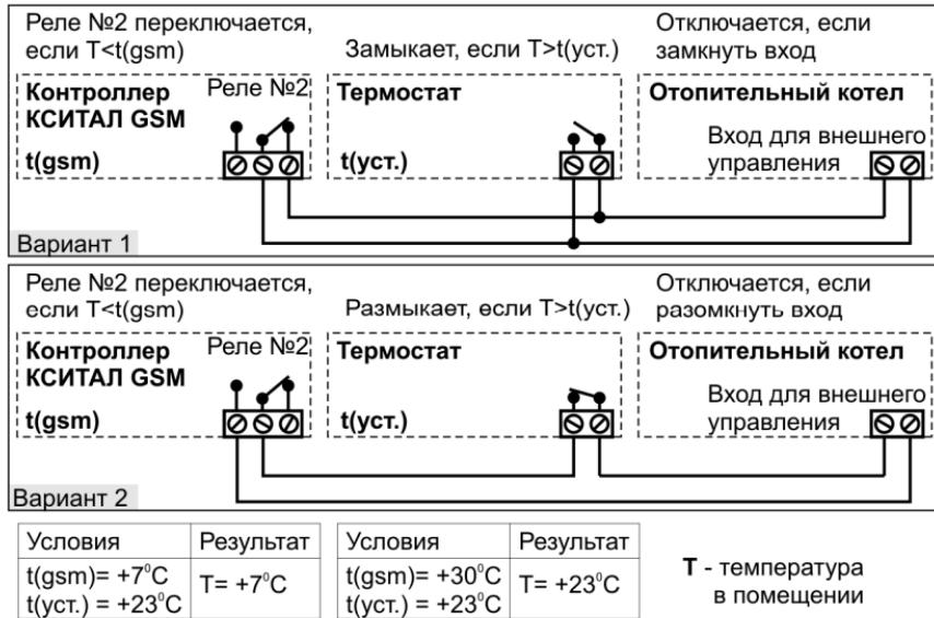
При таком подключении КСИТАЛ-GSM поддерживает дистанционно задаваемое значение температуры (см. раздел "Температура включения нагревателя") в помещении ниже установленной на автономном термостате.
