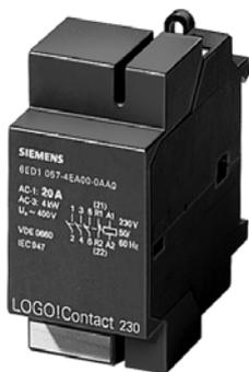
Модули LOGO! Contact предназначены для бесшумной коммутации цепей трехфазного переменного тока напряжением до 400В с активной нагрузкой до 20А или асинхронными электродвигателями мощностью до 4 кВт. LOGO! Contact не имеют интерфейса для подключения к внутренней шине логического модуля LOGO! Управление их работой осуществляется через дискретные выходы логического модуля или модуля расширения DM8.
