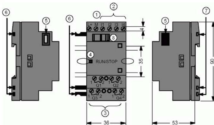
Все модули LOGO! монтируются на 35мм профильную шину DIN или на плоскую поверхность. Объединение всех модулей в единое устройство осуществляется через внутреннюю шину. Внешние цепи монтируются проводами 1x2.5 мм<sup>2</sup> или 2x1.5 мм<sup>2</sup>.
