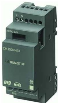
Коммуникационный модуль LOGO! CM EIB/KNX позволяет производить подключение логических модулей LOGO! к сети EIB *Instabus*, используемой для автоматизации зданий. В сети EIB модуль LOGO! CM EIB/KNX выполняет функции ведущего устройства и позволяет опрашивать до 16 дискретных и до 8 аналоговых EIB датчиков, а также управлять работой до 12 EIB дискретных устройств.
