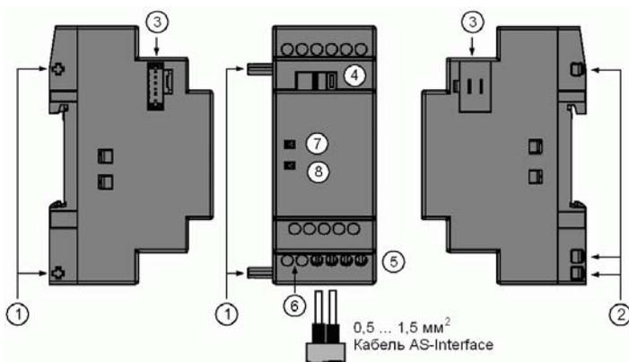
Коммуникационный модуль LOGO! CM выпускается в пластиковом корпусе размерами 36x52x90 мм и имеет степень защиты IP 20.
