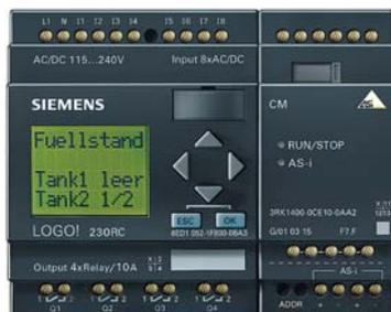
Адреса виртуальных входов и выходов, используемых в программе LOGO!, формируются по следующему правилу. Им присваивается четыре последовательных адреса, следующих за адресом последнего реально существующего дискретного входа или выхода. Например, в конфигурации, включающей в свой состав логический модуль LOGO! 230RC и коммуникационный модуль LOGO! CM, адресация виртуальных входов и выходов будет выглядеть следующим образом:
