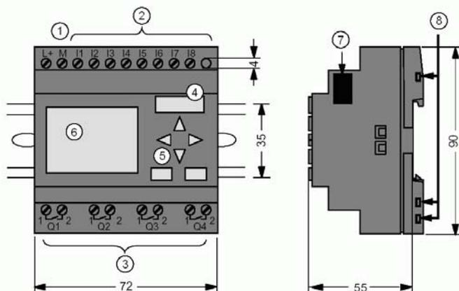
Все модули LOGO! монтируются на 35мм профильную шину DIN или на плоскую поверхность. Объединение всех модулей в единое устройство осуществляется через внутреннюю шину.
