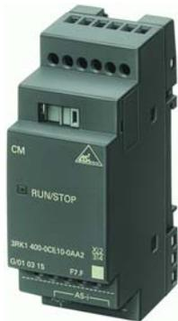
Коммуникационный модуль LOGO! CM поддерживает 4 виртуальных дискретных входа и 4 виртуальных дискретных выхода и выполняет функции ведомого устройства AS-Interface. Он способен передавать информацию о состоянии 4 дискретных входов LOGO! ведущему устройству AS-Interface, а также принимать от него 4 управляющих дискретных сигнала.
