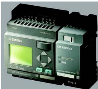
В программе LOGO! EIB входам и выходам присваиваются последовательные адреса, следующие за адресами последних входов и выходов системы локального ввода-вывода. Например, в конфигурации, включающей в свой состав логический модуль LOGO! 12/24RC с двумя аналоговыми входами и коммуникационный модуль LOGO! CM EIB/KNX, адресация сетевых входов и выходов будет выглядеть следующим образом:
