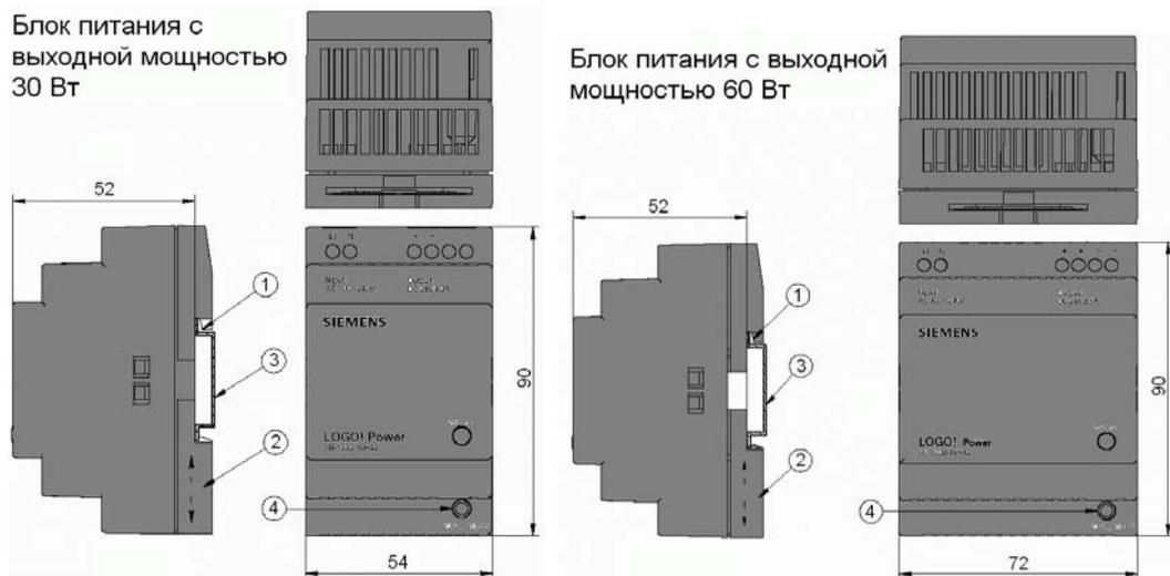
1. Паз для установки на 35 мм профильную шину DIN.
