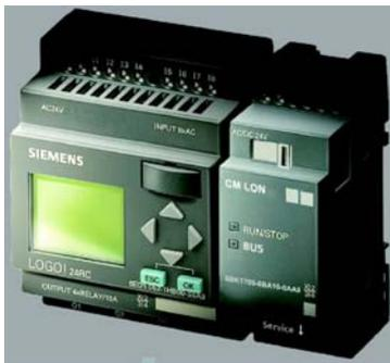
Коммуникационный модуль LOGO! CM LON позволяет производить подключение логических модулей LOGO! к сети LON Works, используемой для автоматизации зданий. В сети LON Works модуль LOGO! CM LON выполняет функции ведущего устройства и позволяет опрашивать до 16 дискретных и до 8 аналоговых LON датчиков, а также управлять работой до 12 LON дискретных устройств.
